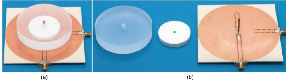
图11. 三频方向图分集DRA模型的照片。(a) 透视图；(b) DR和馈电电路。
