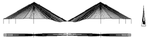
图 4 二期恒载施工阶段的失稳变形图
