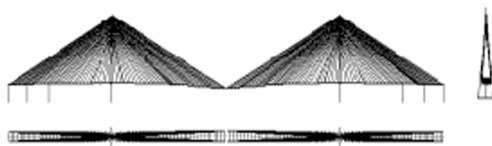
图 3 中跨合龙施工阶段的失稳变形图
