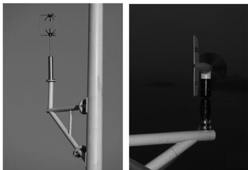
(a) 三向超声风速仪 (b) 螺旋桨式风速仪
