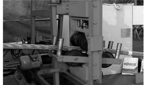
图 11 试用 \phi 5 \times 127 束股调试 Fig. 11 Debugging for \phi 5 \times 127 steel wire trial
