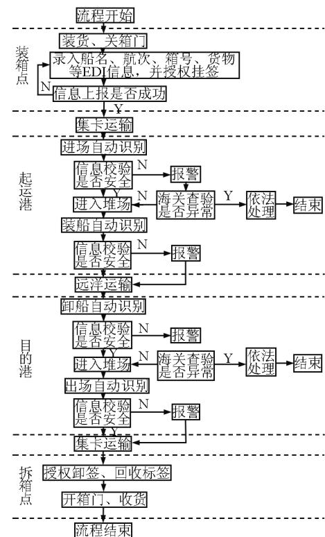
图 5 基于物联网的集装箱物流业务流程图<sup>[5]</sup>
