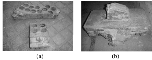
图 3 刮刀、切刀、重型撕裂刀磨损状况图
