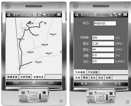
图 5 野外场站巡检移动终端系统
