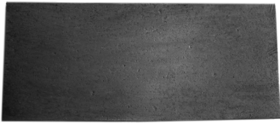
图3 320 °C、0.103 m/s 下清洗 30 h 后样件照片
