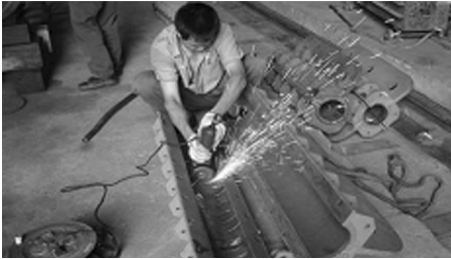
图4 索夹内表面打磨处理
