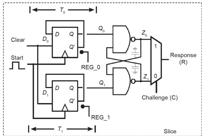
图1. 一位PUF识别信号发生器元件设计。
