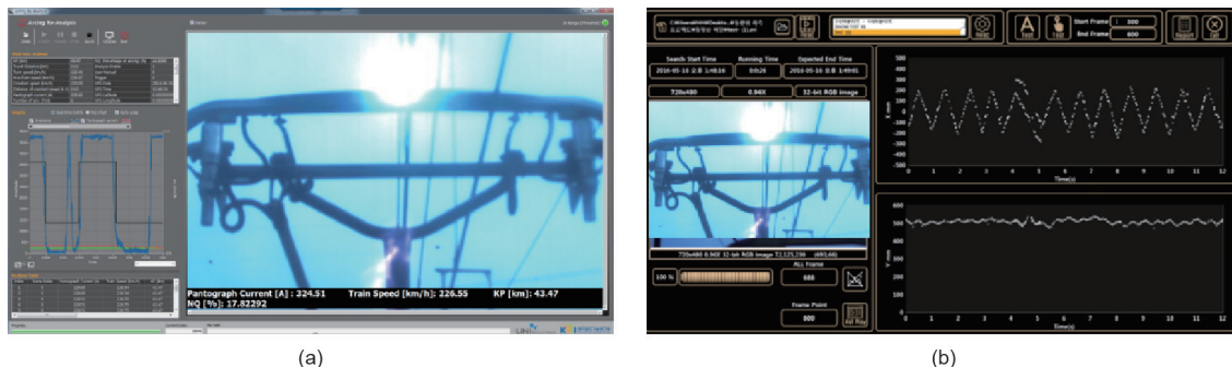
图9. (a)HEMU-430X 400 km·h -1 级上的电弧测量结果; (b)HEMU-430X 400 km·h -1 级上动态拉出值/高度的测量结果。
