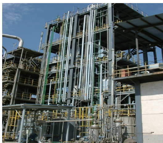
图3. 10 \text{kt}\cdot\text{a}^{-1} 气相贝克曼重排工业示范装置。
