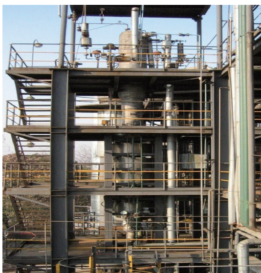
图7. 6 \text{ kt} \cdot \text{a}^{-1} CPL磁稳定床反应器工业示范装置。
