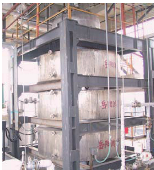
图8. 100 \text{ kt} \cdot \text{a}^{-1} CPL磁稳定床加氢精制装置。
