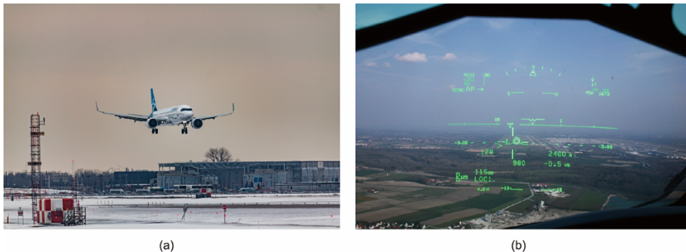
图2. (a) 当飞机在低空飞行时，尤其是在低能见度条件下着陆时，无线电高度表至关重要。(b) 飞机驾驶舱内的平视显示器可以将高度和风速等主要飞行信息投射到飞行员视线范围内的显示屏上。该系统依赖于无线电高度表并可能受到5G干扰。来源：Vincent Albos (CC0)；Joschiki (CC BY-SA 3.0)。
