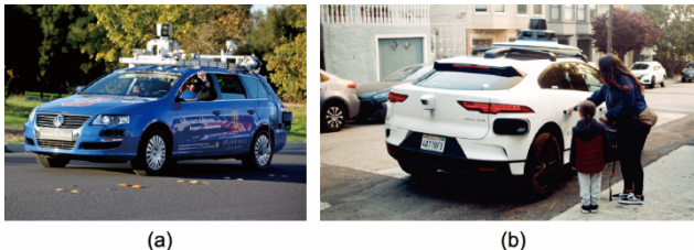
图1. (a) 美国加利福尼亚州帕洛阿尔托市斯坦福大学推出的大众自动驾驶原型车，和(b) 谷歌自动驾驶汽车独立子公司Waymo(美国加利福尼亚州山景城)推出的机器人出租车，它们的特点在于车顶安装了大型激光雷达装置，以帮助车辆探知周围环境并进行导航。来源：(a) 网络相册(Flickr)(CC BY 2.0)；(b) Waymo(公共领域)。
