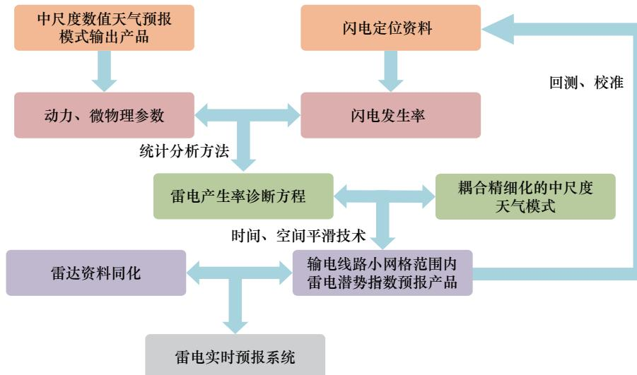
图2 电力气象灾害精细化预报预警技术框架
