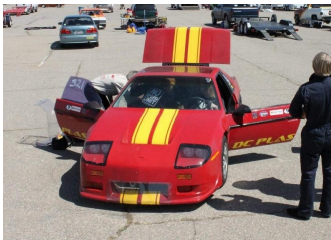
图 1. John Metric 对这辆庞蒂亚克菲耶罗进行了升级,在原来的油箱位置增加了两个电动马达,并安装了一组 375 V 的锂聚合物电池。该车在 9.898 s 内跑完了 1/4 mi (0.4 km),创造了同级别电动赛车记录。来源: John Metric, 经许可。
