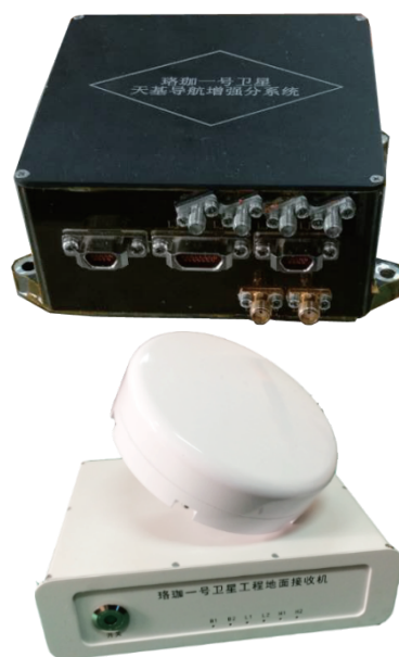
图 4 “珞珈一号” LEO-NA 载荷(上)和地面接收机(下)
