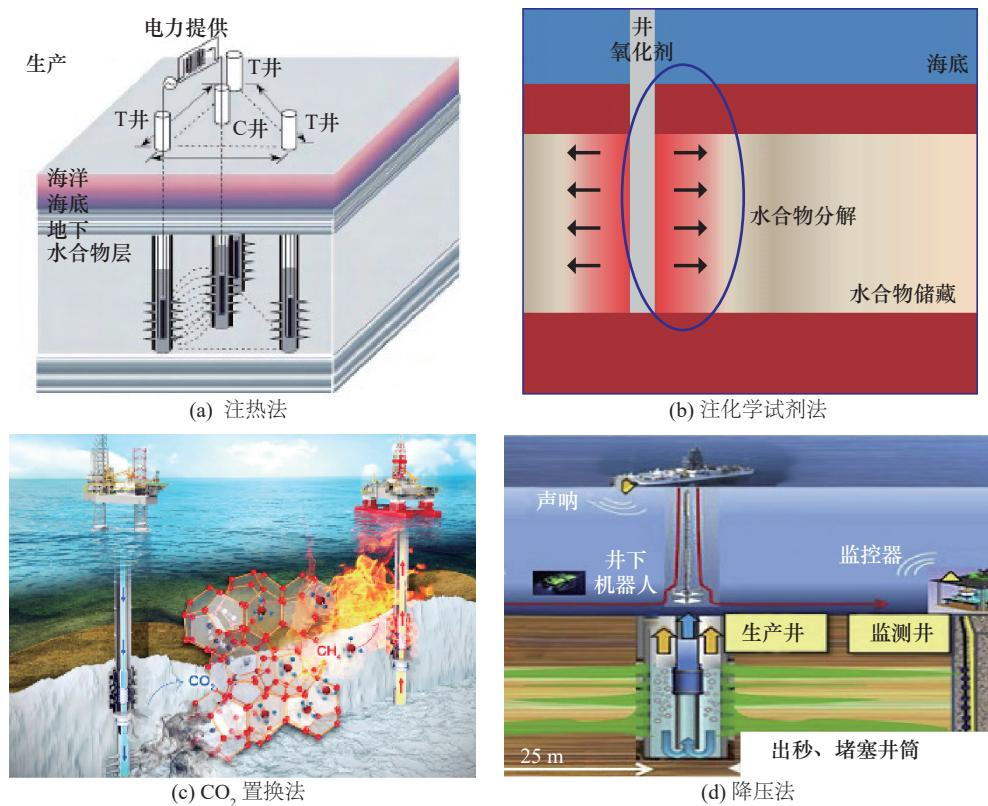
图1 水合物传统开采方法的工艺原理示意图
