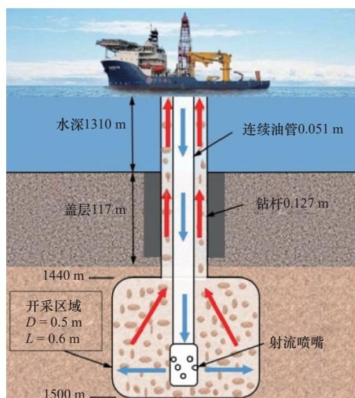
图 2 海洋天然气水合物固态流化试采工艺 [20]
