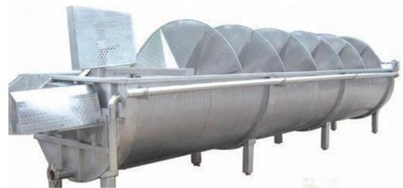
图2 螺旋预冷机
