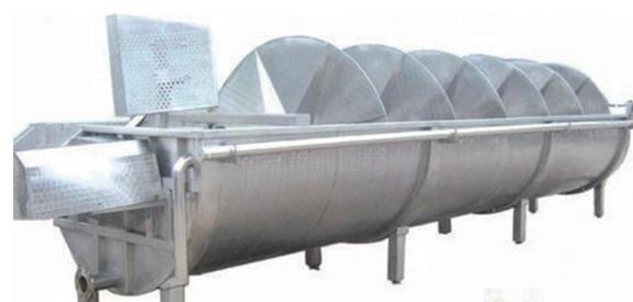
图2 螺旋预冷机
