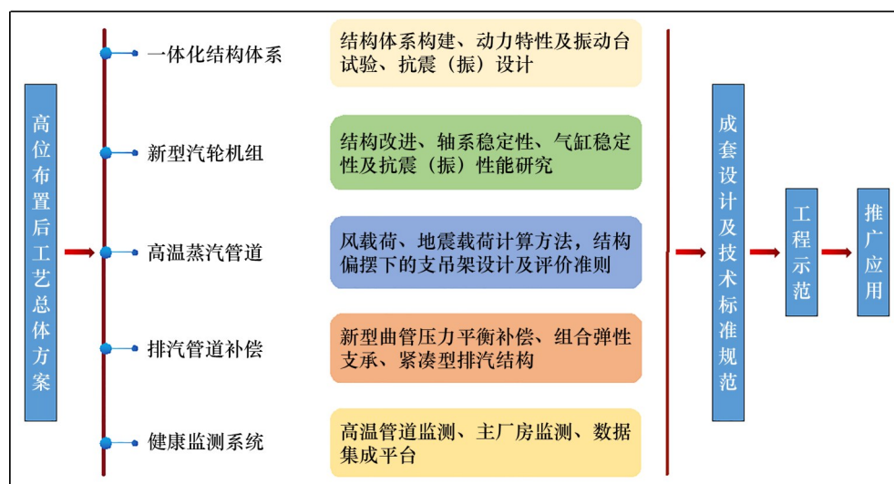
图1 汽轮发电机组高位布置技术总体方案
