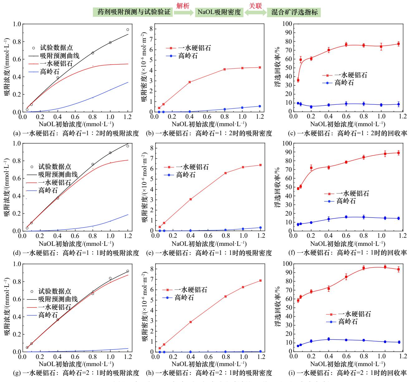
图5 不同比例一水硬铝石和高岭石混合矿对油酸钠的吸附预测及浮选试验验证
