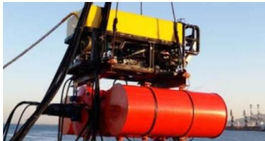
图5 ROV 携带水下抽油清污一体化机
