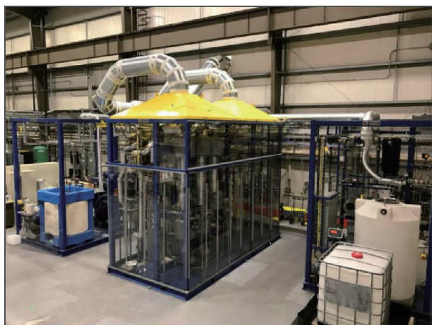
图1. PNNL开发的一个装配有工程滚轮的HTL生产单元。在其右前方有一个大约1 m 3 的大玻璃罩。
