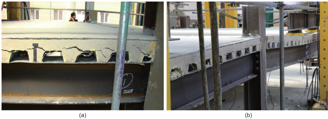
图19. (a) 超负荷时不使用U-bars的混凝土板边缘处的开裂情况；(b) 使用U-bars的边梁变形情况。
