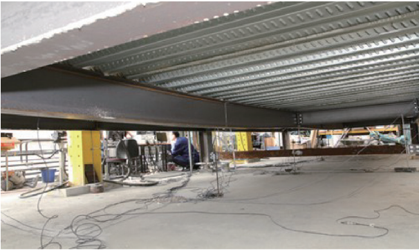
图12. 内部次梁在达到最大荷载时的挠度。
