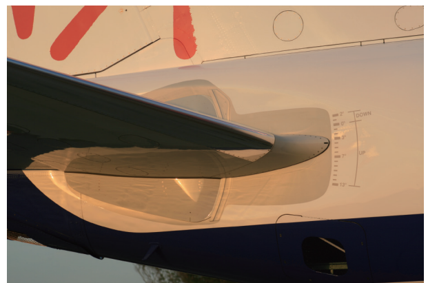
图1. 在某些情况下，波音737 Max 8的MCAS系统旨在自动移动水平安定面，就像Embraer ERJ-170上的水平安定面一样，将飞机机头向下推以防止失速。图片来源：YSSYGuy，维基百科（CC BY-SA 3.0）。
