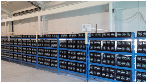
图1. 处理加密货币交易所需的密码学问题难度极大, 必须通过试错法解决。该过程通常由被称为“矿机”的专门计算机系统执行, 该系统可能被部署在成千上万台机器中, 例如, 图中机组就位于冰岛的加密货币采矿“农场”。据一些研究估计, 这种计算活动的能源消耗是巨大的, 甚至与整个国家的能耗水平相同。图片来源: Marco Krohn, 维基共享资源 (CC BY-SA 4.0)。
