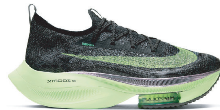
图1. 穿着耐克公司最先进的Air Zoom Alphafly NEXT%跑鞋的精英运动员正在打破长期以来的纪录。这双鞋的特点是采用了具有完整内弯碳纤维板的宽大楔形ZoomX（聚醚嵌段酰胺）泡沫，以及在前脚掌搭载了一对Zoom Air Pods。图片来源：Nike（公共领域）。
