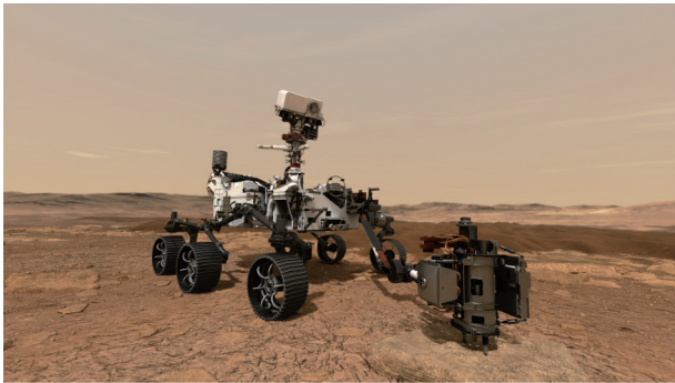
图1. 一位艺术家的效果图展现了NASA的毅力号火星探测器在火星上的Jezero Crater中钻探能够证明火星上曾经存在生命的岩心。探测器将收集并保存大约30个岩石和土壤样本以便未来进行进一步的考察，然后返回地球。图片来源：NASA/JPL-Caltech（公共领域）。
