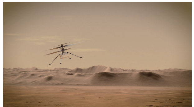
图2. 毅力号火星探测器可以发射高约0.5 m、重约1.8 kg的微型直升机。正如这位艺术家所描绘的，如果Ingenuity直升机能够成功飞行，它将是第一个在另一颗行星上飞行的飞行器。为了在火星稀薄的大气层中起飞上升，Ingenuity的叶片将以每分钟2400转的速度旋转，大约为地球上普通直升机转速的5倍。美国国家航空航天局预计它将进行五次短暂的试飞，每次试飞时间约为90 s。图片来源：NASA/JPL-Caltech（公共领域）。
