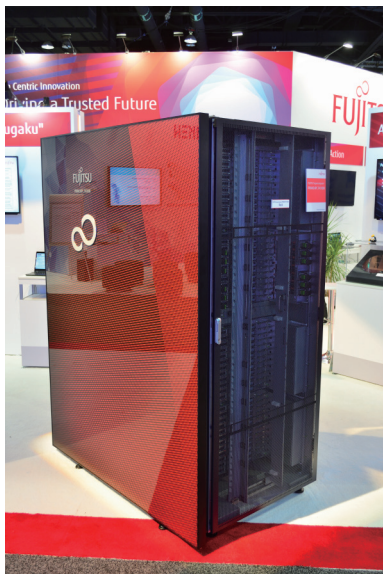
图1. 一个机柜包括近15.9万个节点，这些节点连接在一起为“富岳”超级计算机供电。整台机器占地面积为1950 m 2 ，相当于3个网球场的面积。资料来源：Raysonho (CC BY-SA 4.0)。
