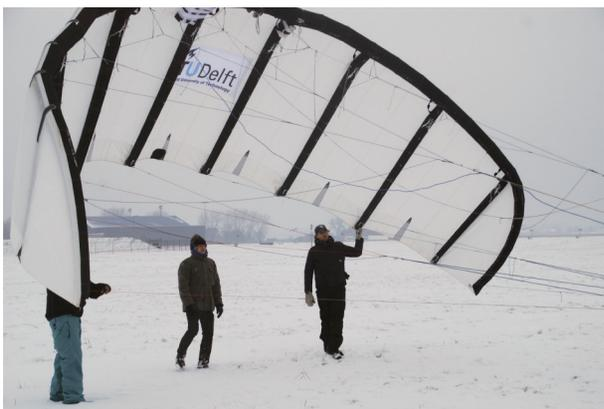
图1. 2013年，荷兰代尔夫特理工大学航空航天工程专业的研究生发射了一个25 m<sup>2</sup>的实验性软翼能量风筝，利用缆绳上绞车的牵引力来对抗风力，帮助风筝提高升力。在过去10年里，小而灵活、拥有简单曲线设计的风筝，其尺寸已经比图中的风筝大得多。事实证明，这些软翼风筝适用于小范围使用的中等功率的AWE系统，如毛里求斯共和国于2020年11月从德国Skyails公司购买的首个商业销售系统[7]。预测和控制更大、更强的软翼AWE风筝的运动更难也更复杂，仍有待进一步研究和测试。资料来源：TU Delft，获得许可。
