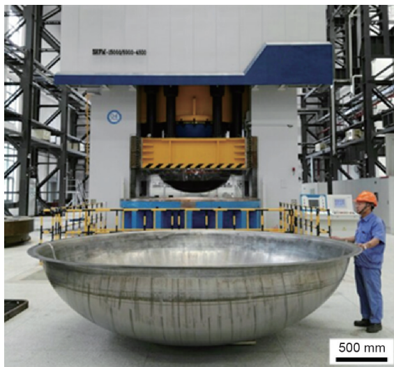
图11. 超大型流体压力成形设备及整体箱底件[36]。
