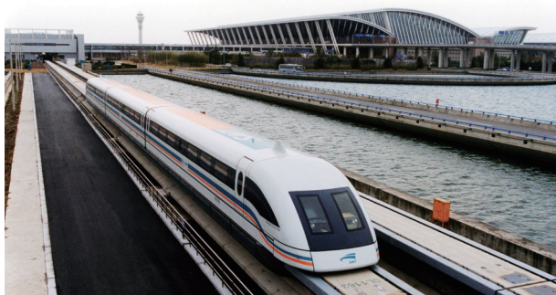
图1. 世界上最长、历史最悠久的磁悬浮线路，最高时速为431 km，横跨上海浦东机场与城市东侧龙阳路之间的30 km路段。图片来源：Alex Needham (public domain)。
