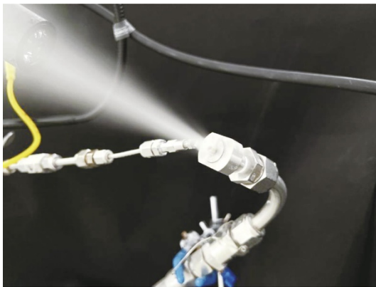
图3. 海洋云层增亮技术现场试验中的定制喷嘴会产生大量极小的海盐粒子（干燥直径约50 nm），通过在小腔体中制造高压的两相流动混合物，喷出空气及液滴，并避免因迅速碰撞导致粒子体积变大。来源：Palo Alto Research Center，经允许。
