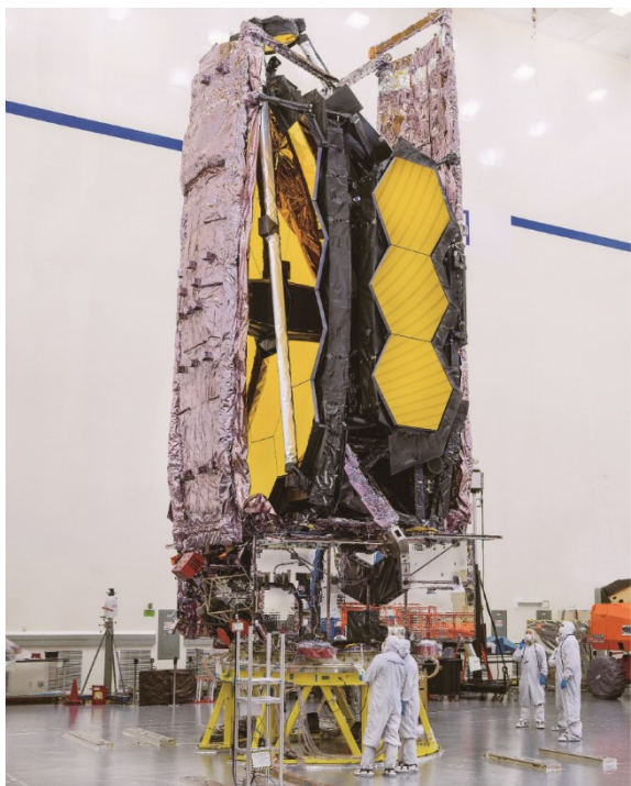
图3. 为了能装进火箭的整流罩，发射前对望远镜进行了折叠。来源：NASA/Chris Gunn (CC BY 2.0)。
