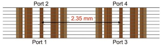
图 13. 通过相邻信道的过渡在两个垂直方向建立的耦合模型。
