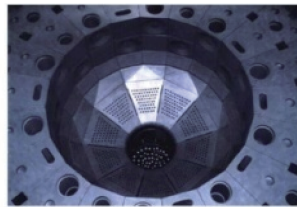
第二代核石墨, 代表: IG-110 (应用于HTR-10, HTTR) H451 (拟用于美国气冷堆) ATR-2E (拟用于德国气冷堆)
