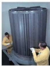
第一代核石墨, 代表: CGB (MSRE), AGOT, PGA (早期气冷堆)
