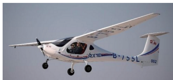
图 1 我国首款电动轻型运动飞机——锐翔 RX1E
