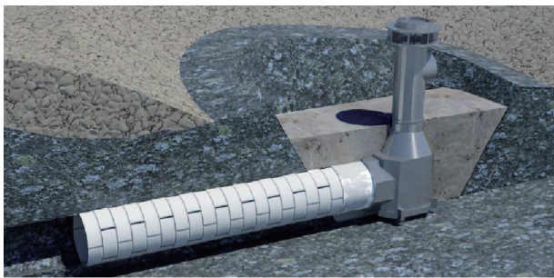
图7. 取水建筑物透视图。
