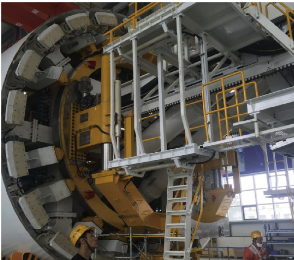
Fig. 14. The segment erector.
