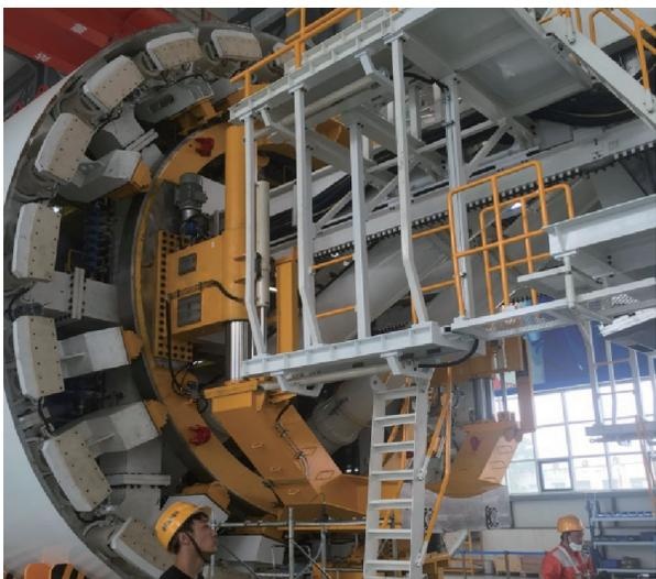
图14. 异形管片拼装机。
