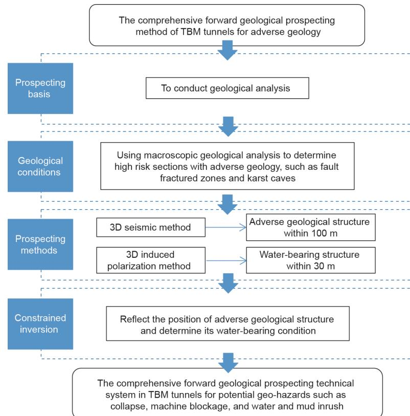
图1. TBM施工隧洞综合超前地质预报技术体系。
