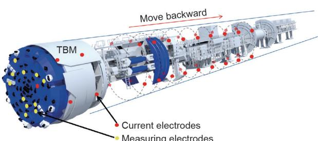
图2. TBM施工隧洞三维激发极化超前地质预报观测示意图。
