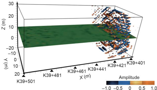
图6. 地震法探测三维成像图。
