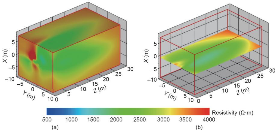
图9. 三维激发极化探测结果图。(a) 三维反演成像图; (b)  $X=0$ 切面结果图。
