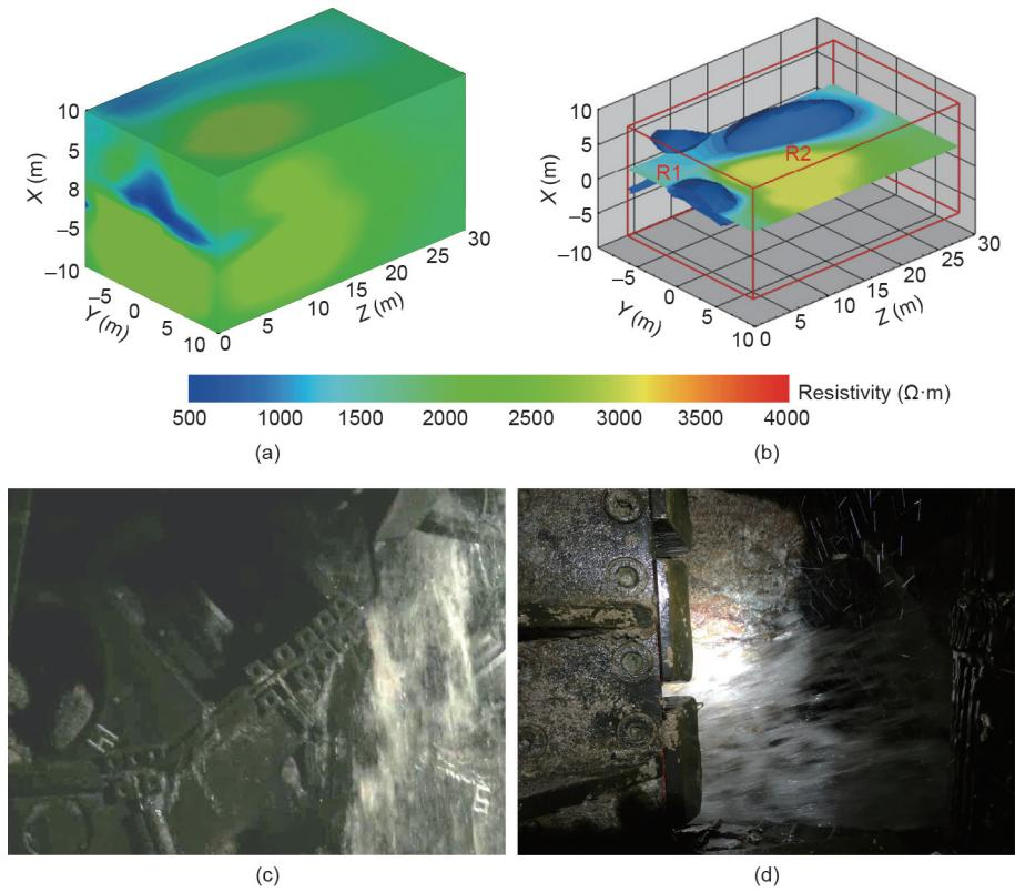
图5. 三维激发极化探测结果与开挖揭露。(a) 三维反演成像图; (b) 低阻体提取结果图; (c) 刀盘内开挖揭露涌水照片; (d) 溜渣口涌水照片。
