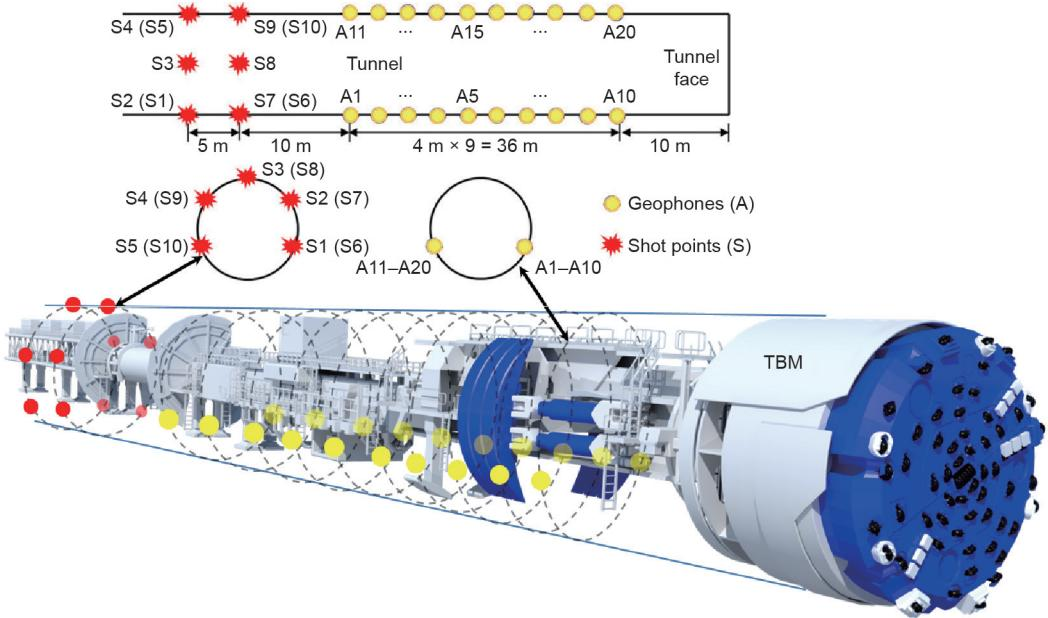
图3. TBM施工隧洞地震超前地质预报观测示意图[15]。
