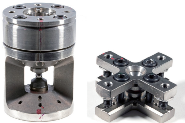
图2. (a) 双柱全景DAC; (b) 四柱交叉DAC。X射线束垂直于径向的压缩轴方向。
