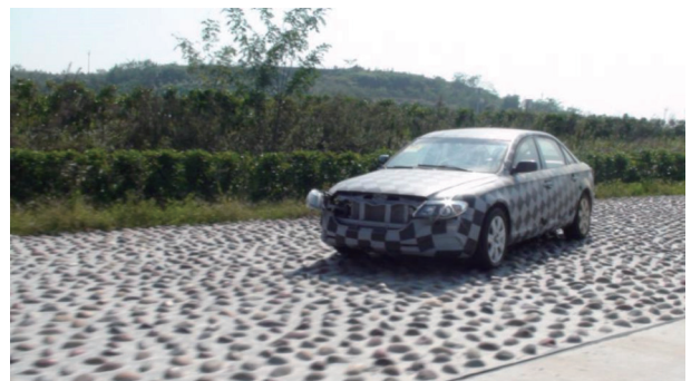
图1. 某试验样车在强化路面上测试。
