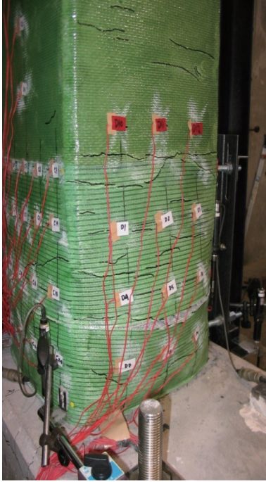
图2. PET纤维布保护层,具有高变形性且不断裂。
