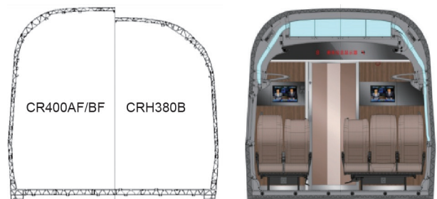
图10. 复兴号动车组车体断面。
