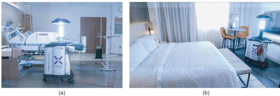
图1. 安装在医院房间（a）和酒店房间（b）内的Xenex LightStrike机器人，在使用过程中是静止的，但其“头部”可上下移动，并且氙灯通过紫外线每秒产生多次脉冲，紫外线的光谱范围为200~315 nm。图片来源：Xenex，已获授权许可。
