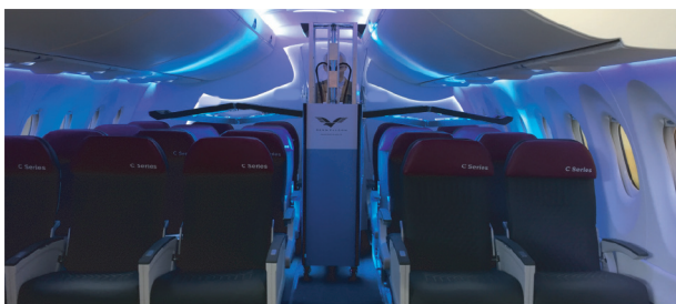
图2. GermFalcon是一种紫外线消毒设备，可以在飞机过道上上下移动。它需要一个由紫外线防护罩保护的操作员来推动它。图片来源：Diner UVC，已获授权许可。
