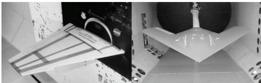
图4. 美国国防高级研究计划局（Defense Advanced Research Projects Agency, DARPA）使用SMA驱动的智能机翼。经SAGE Publications, ©2004许可，转载自参考文献[24]。
