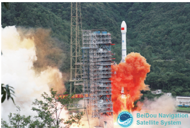
图1. 经过过去20多年的大规模扩张，全球导航卫星系统星座规模增加了大约4倍，其导航定位能力和服务也得到了改善。卫星数量和性能的飞跃，大多要归功于中国和欧盟自21世纪初以来数百亿美元的投资和伟大的航天器设计、建造和发射计划以及广泛的航空航天基础设施建设。2020年6月23日，中国第55颗北斗导航卫星在西昌卫星发射中心成功发射，此次发射将北斗导航卫星射入距地球上空约36 000 km的地球静止轨道。北斗导航卫星的成功发射使该系统的运行卫星数量增加到45颗，其中的30颗组成了全面运行的卫星导航星座。来源：China Satellite Navigation Office（公开）。
