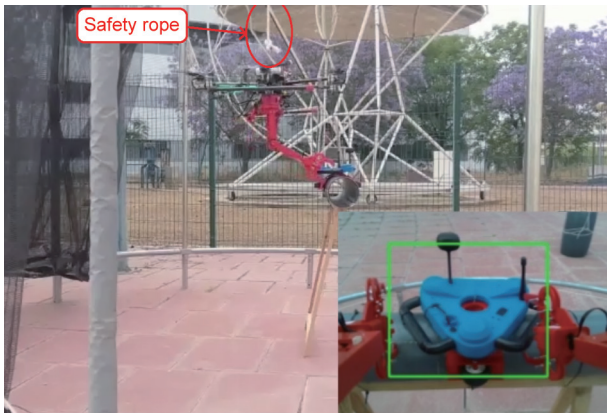
图16. 附加安全绳的户外自主测试。
